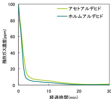
テスト方法: 容量3Lの臭気袋にKD-311 0.5gと悪臭ガスを封入し、経過時間における悪臭成分の濃度を測定
